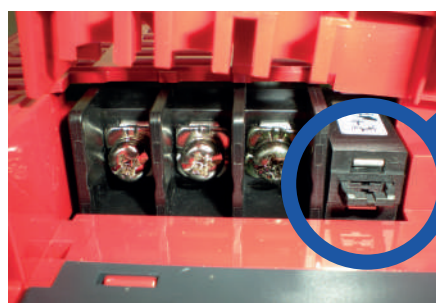
FILTRE ACTIF (PAR DÉFAUT) : LANGUETTE POUSSÉE
